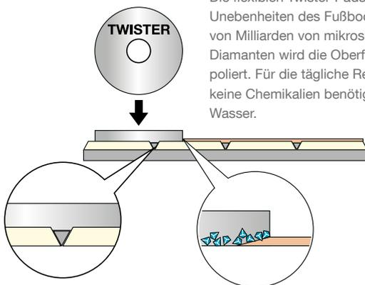
Die flexiblen Twister-Pads folgen den Unebenheiten des Fußbodens und mithilfe von Milliarden von mikroskopisch kleinen Diamanten wird die Oberfläche mechanisch poliert. Für die tägliche Reinigung werden keine Chemikalien benötigt – nur gewöhnliches Wasser.
